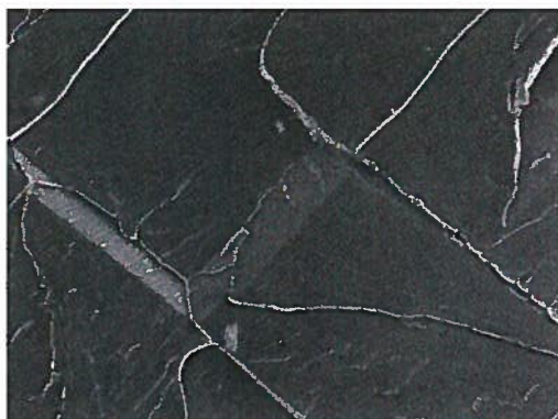
Figuur 7 - SEM-opname breukvlak, 1000x. Detail van splijtbreuk aan de tweelingen, waardoor blokvormige tot kubische structuren op het breukvlak zichtbaar waren.
