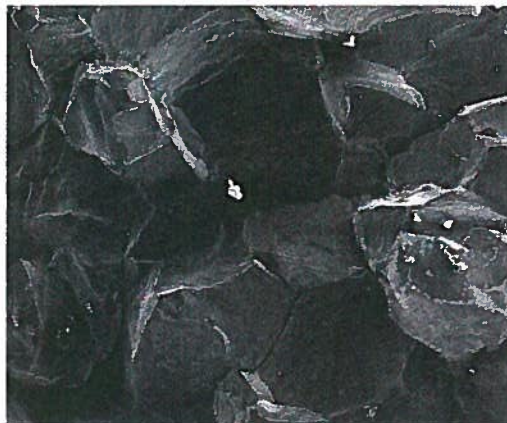
Figuur 6 - SEM-opname van het breukvlak, 100x. Ter plaatse liep de breuk overwegend langs de korrelgrenzen en plaatselijk splijtbreuk aan tweelingen.
