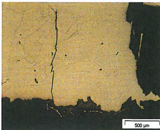
Figuur 5 - Breukvlak 50x, etsmiddel nital drie procent. De breuk liep deels langs de korrelgrenzen van het ferriet en deels langs tweelingen. Onder het breukvlak is een subscheur aanwezig die overwegend langs tweelinggrenzen loopt.
