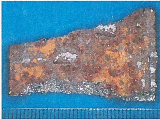
Figuur 1 - Een afgebroken stuk van een paalschoen
